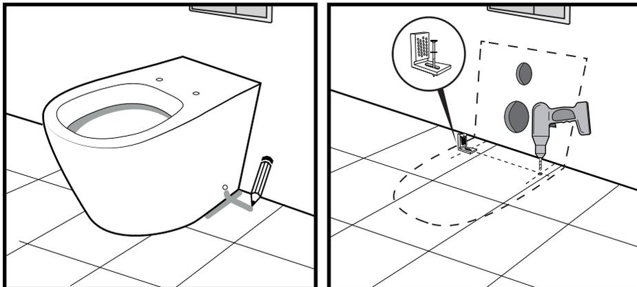
Si se han adecuado los tubos correctamente y los anclajes se encuentran seguros sujetos al suelo, lleve hasta la pared el inodoro y encájelo todo en línea de forma precisa.
