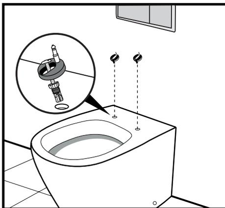
Coloque la tapa sobre las bases e insertando los espárragos en los orificios de la tapa hasta que oiga un "click".
